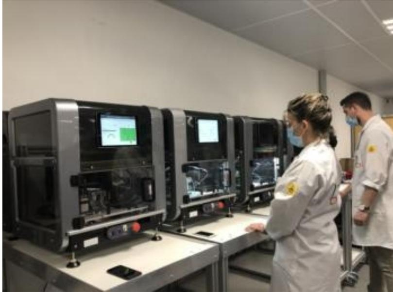
Largo a investi dans ces robots pour automatiser les tests sur les téléphones usagés dans ses locaux de Sainte-Luce-sur-Loire.
